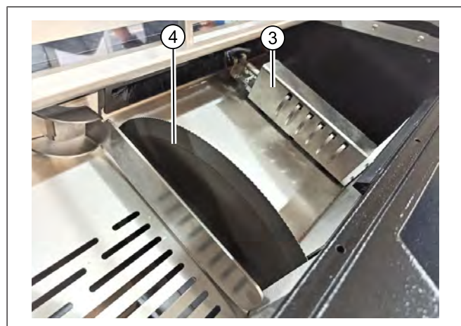
Bild 57: Rengöring av kniven
