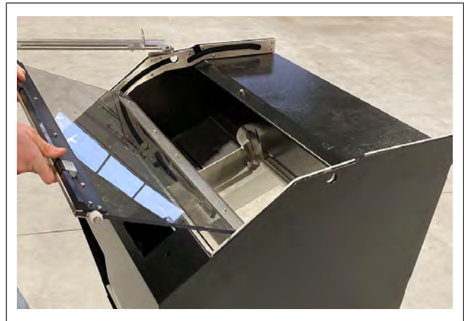
Bild 46: Rengöra skyddskåpan och styrskenorna
