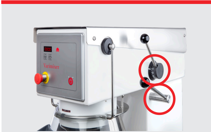
VL-1 – Manuel hastighedsregulering og manuel kedelsænkning
