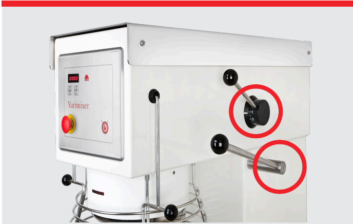
VL-1 – Manuel hastighedsregulering og manuel kedelsænkning
